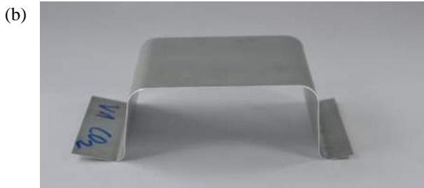
Abbildung 22: (a) Trocken und mit (b) CO<sub>2</sub>-Schmierung gezogenes U-Profil.
